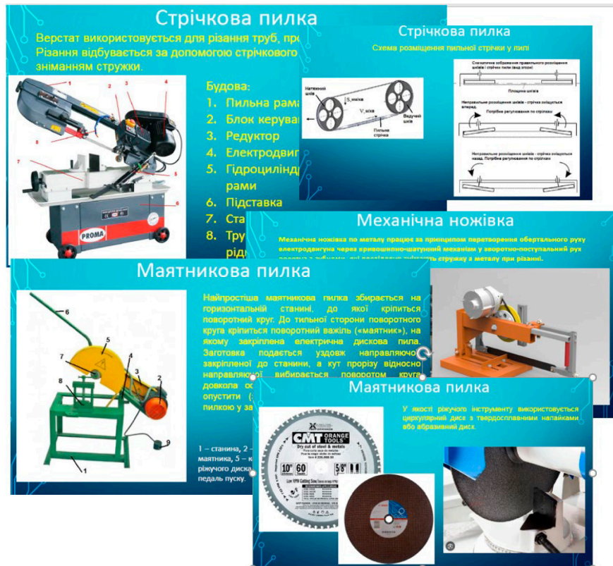
Рис.6. Обладнання для механізованого різання металу
